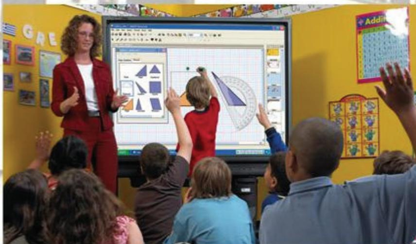
Si tratta di una speciale lavagna grande quanto quelle che siamo abituati a vedere nelle nostre classi, ma questa è forse l'unica analogia con la vecchia lastra di ardesia. La LIM è un grande schermo collegato ad un proiettore e ad un computer; la sua particolarità sta nel fatto che si possono dare i comandi direttamente dalla lavagna utilizzando le dita come un mouse: si scrive o si disegna sfiorandone la superficie, e questo già ci stuzzica,
